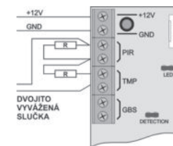
Príklad zapojenia detektora JS-20 LARGO do dvojito vyváženej slučky pre iné ústredne.
